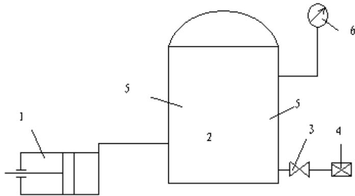
图1 储气罐充填法（风包法）测量布置示意图
